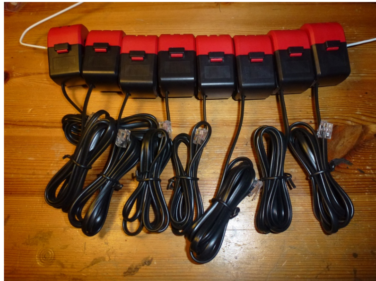
Abbildung 24: Stromwandler vom Typ CT30-A.
